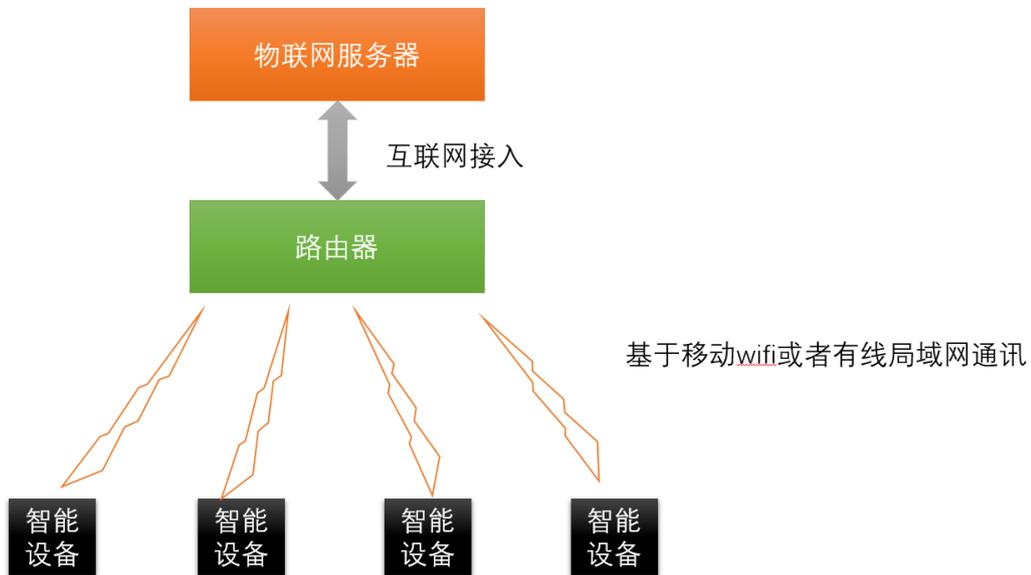
此中架构，适合于所有的物联网设备都是运行在一个局部环境中，设备通过 wifi 或者有线连接到路由器，而由路由器统一连接的物联网服务器，就如同我们家中装一个 wifi 路由器上网一样的架构，需要注意的事项：
