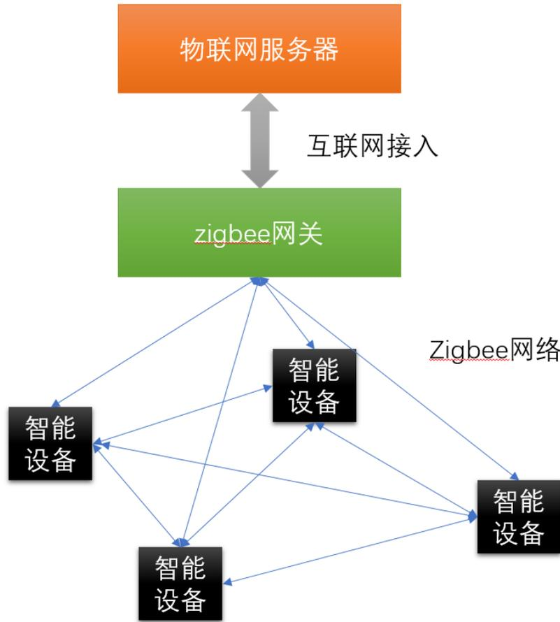
zigbee 接入网络也依赖于 zigbee 网关，网关本身也是一个 zigbee 设备，zigbee 设备是自组网的，在使用过程中注意的问题有
